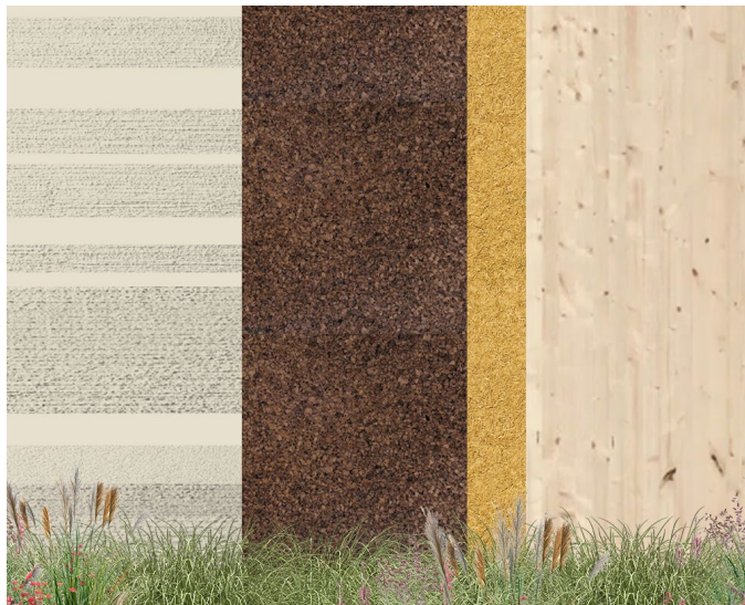
Biobased materialenpalet: Stucwerk met geborstelde belijning, geëxpandeerd kurk, houtvezel isolatie materiaal en kruislaags verlijmd hout
