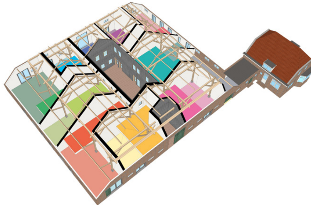
De hoevewoningen in de schuur zijn zo gepositioneerd dat de oude houten draagconstructie overal in het zicht blijft
